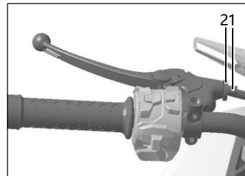
Debriyaj kolunun ucundaki boşluk: 5-8mm.
